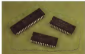
Processore Z80, RAM e ROM Mac rappresentano il "cuore" del piccolo portatile
